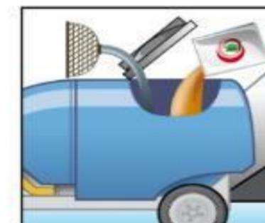
Miscelare mantenendo in agitazione e portare il serbatoio a volume
